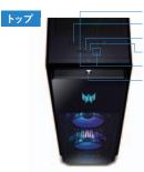
USB 3.2ポート(Type-C) 2.5" ホットスワップベイ ヘッドフォン/スピーカー・ジャック マイクロフォン・ジャック USB 3.2ポート(Type-A)
